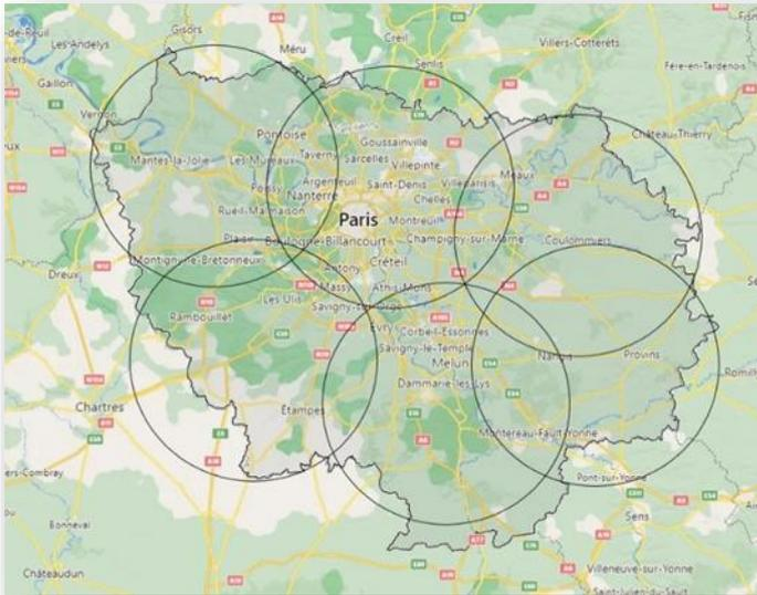
A partir de ces informations, nous avons représenté un réseau de capteurs à l'échelle du territoire de l'Île-de-France. Avec un rayon de 30 km par capteur, 6 capteurs seraient nécessaires pour couvrir le territoire.
